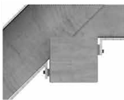
**2** - Raccordement à une panne : utilisation de mastic colle. Avec contre latte clouée.
