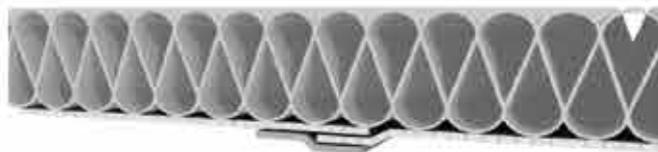
**1** - Recouvrement entre lés avec adhésif ADHEO UNIVERSEL. Il convient d'assurer la continuité du film pare vapeur en prenant un soin particulier dans les raccords entre lés. Pour cela assurer un recouvrement minimal de 5cm et utiliser le ruban adhésif ADHEO UNIVERSEL pour les raccords entre lés.
